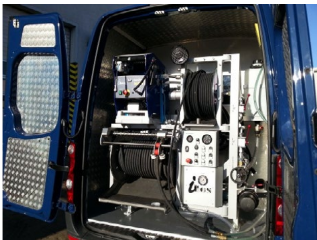
Vysokotlaké čisticí zařízení HydroMax umístěné v dodávkovém voze
